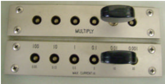
写真 D 3-2 ブリッジボタン G 0 を押して測定する。
