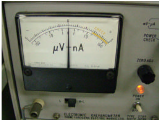
写真 D 4-1 検流計の振れが「0」になるように
